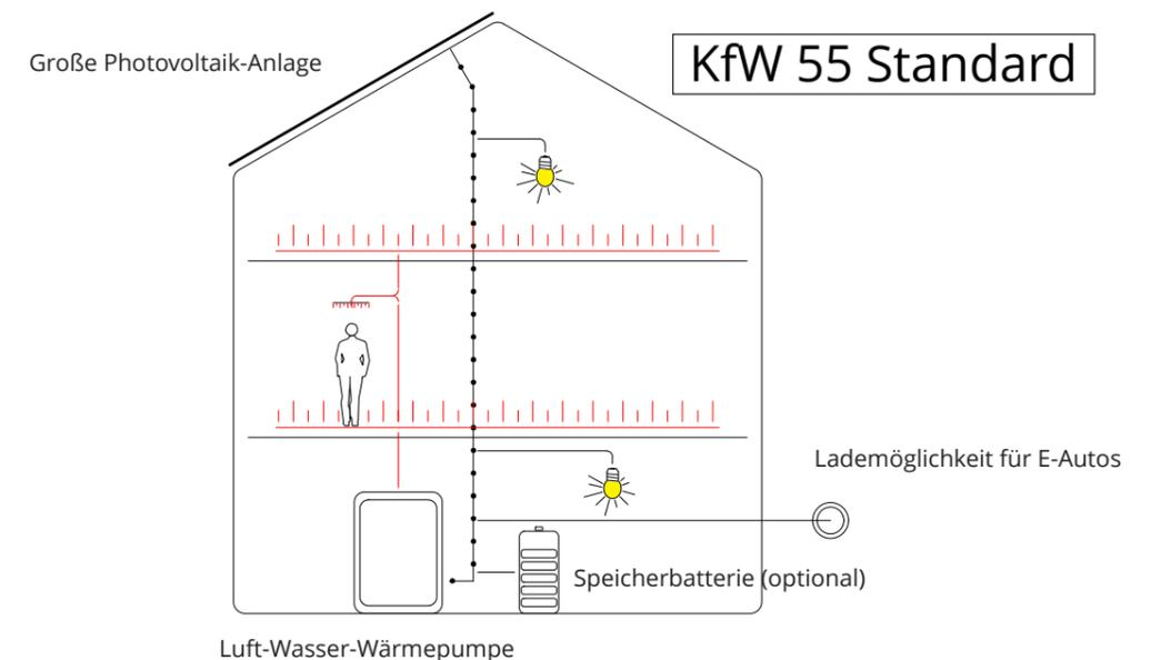
So funktioniert die Technik im Plusenergiehaus: Die Photovoltaik-Anlage mit Hochleistungsmodulen liefert den Strom für den Betrieb des Hauses.
